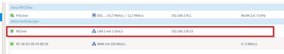
Die IP-Adresse wird unter WIZnet angezeigt und ist nicht die gleiche wie das des WLANs.
